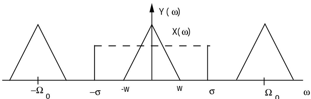
En estas condiciones,  $x(t)$  puede recuperarse a partir de  $y(t)$  mediante un filtro paso bajo ideal (línea de puntos).
