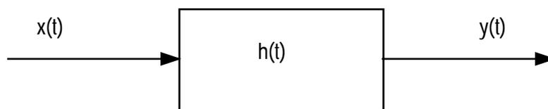
$$Y(\omega) = X(\omega)H(\omega) = H(\omega) \sum_{n=-\infty}^{\infty} \frac{X_b(n\omega_0)}{T_0} 2\pi \delta(\omega - n\omega_0)$$
